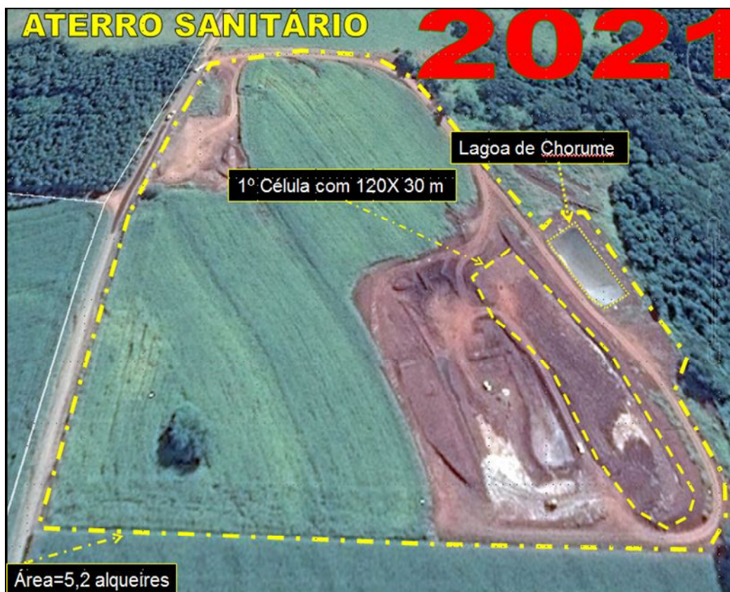
Figura IX.7: Layout do Aterro Sanitário do município de Marechal Cândido Rondon.
